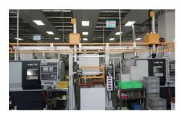
※ 车床取放 双通道二对二桁架 (共用料盘轴)
